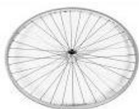
Koło z polerowaną piastą, 36 szprych, splot prosty
